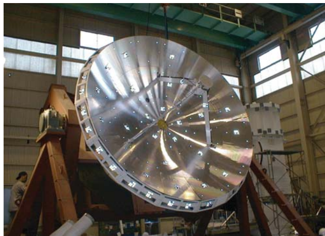
アタカマに移設するNANTEN2用の高精度鏡面
